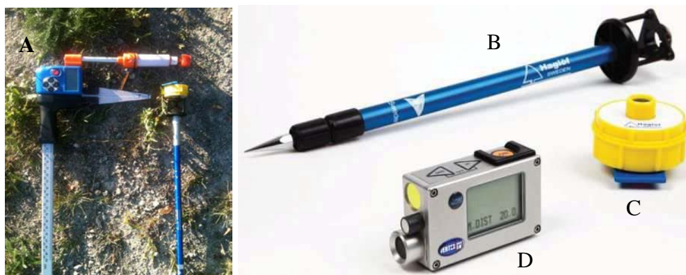
Figur 4. Utrustning som användes vid fältarbetet. A. Haglöfs dataklave Digitech Professional® B. Centrumpäpp med adapter C. Transponder T3 D. Höjdmätare, Haglöfs® Vertex IV. (Norra Skogsägarna, 2015c).
