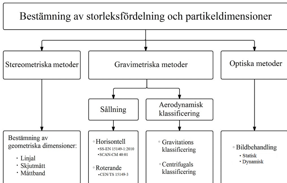
Figur 1. Schematisk bild över olika metoder vid fastställande av storleksfördelning och partikeldimensioner för fasta biobränslen (Källa: Översatt och modifierad figur från Böhm (2006)). Figure 1. Schematic representation of different methods for the determination of the size distribution and particle dimensions for solid biofuels (Source: Translated and modified figure from Böhm (2006)).
