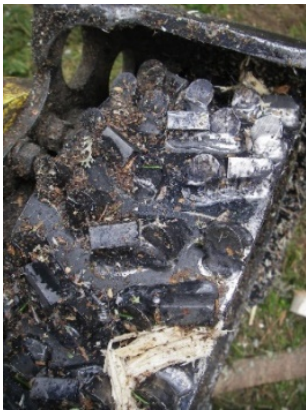
Foto: Jonas Blomqvist Figur 3. Dubb på yttre matarhjul Figure 3. Spikes on the outer feed wheel
