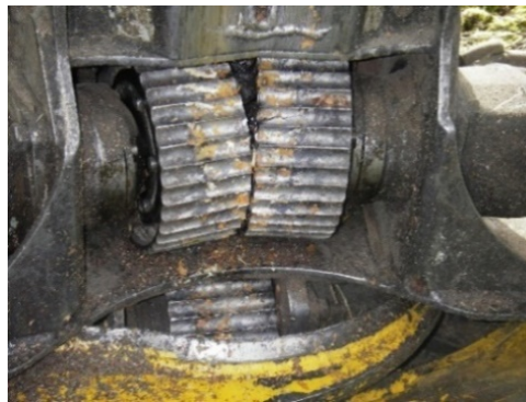
Foto: Jonas Blomqvist Figur 6. Ribb som bröstmatarhjul Figure 6. Rib on the inner feed wheel
