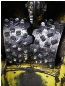
Foto: Jonas Blomqvist Figur 4. Dubb som bröstmatarhjul Figure 4. Spikes on the inner feed wheel
