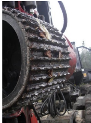
Foto: Jonas Blomqvist Figur 5. Ribb på yttre matarhjul Figure 5. Rib on the outer feed wheel
