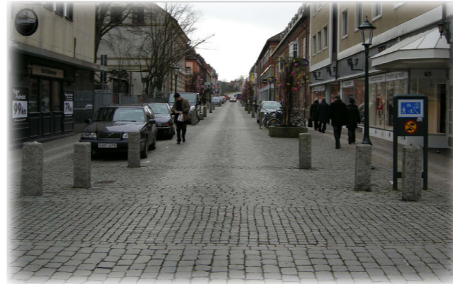
Avsmalning av gata med hjälp av pelare och markerade parkeringsplatser
