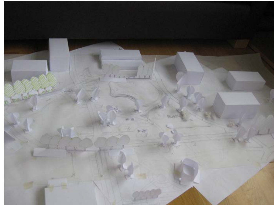
Genom ett skissunderlag i skala 1:200 och byggnader och hus i samma skala provade jag mig fram för att förstå samt närma mig den utformning jag önskade på platsen. Modellen hade inget presentationssyfte utan fungerade enbart som 3D-skiss.
