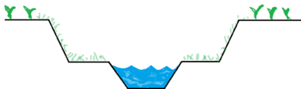
Figur 2. Schematisk ritning av tvärsnittet hos ett tvåstegsdike.
