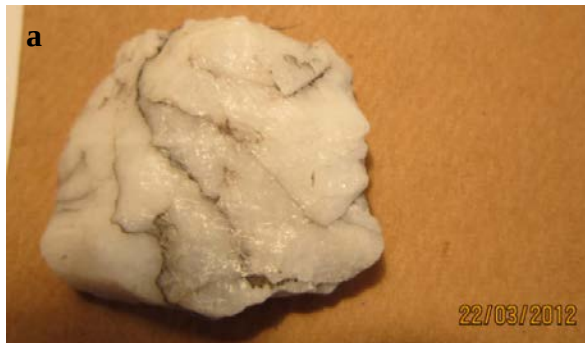
Figur 15a. Kvarts, försök 1a, djup +3, före bränning.
