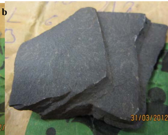
Figur 16b. Skiffer, försök 3b, djup +3, efter bränning.
