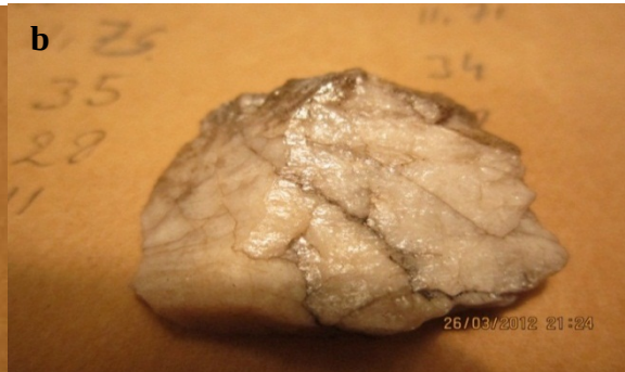
Figur 15b. Kvarts, försök 1a, djup +3, efter bränning.
