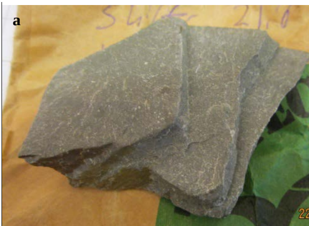
Figur 16a. Skiffer, försök 3b, djup +3, före bränning.
