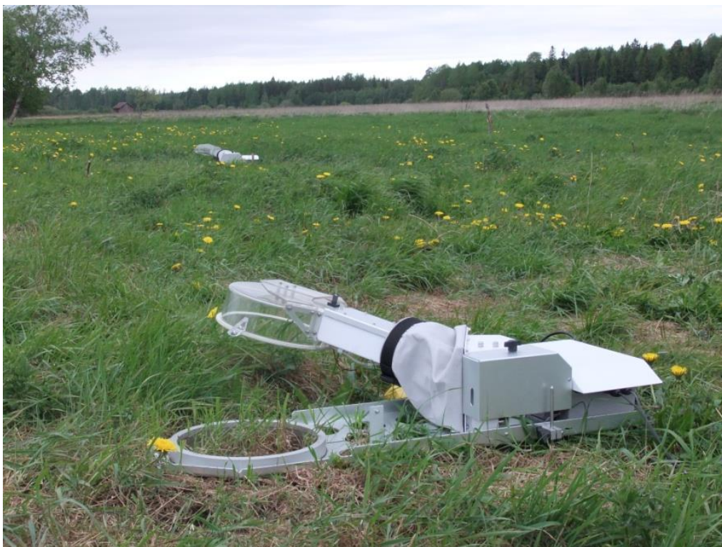
Figur 6. Automatisk station för mätning av respiration, på bilden i vänteläge.
