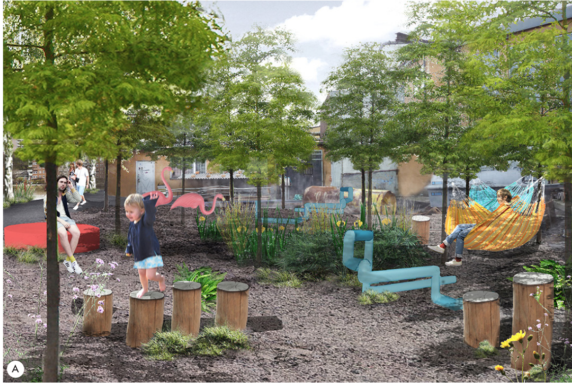
I den östra infiltrationsytan finns en rain garden som renar tillkommande vatten. Via ett rör leds det reade vattnet bort för att kunna användas vid odlingen.
