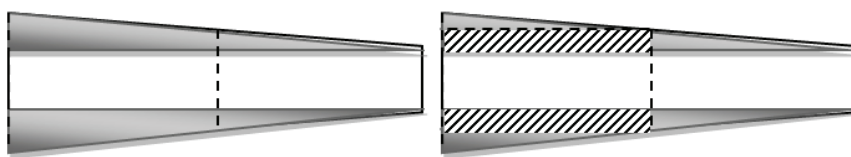
Figur 8. Vänster: En lång stock där den gråa ytan är utbytesförlust. Höger: Samma stock avterad i den mittersta linjen till två stockar. Utbytet stiger då med den streckade ytan. (Hedin pers. medd. 2012)
