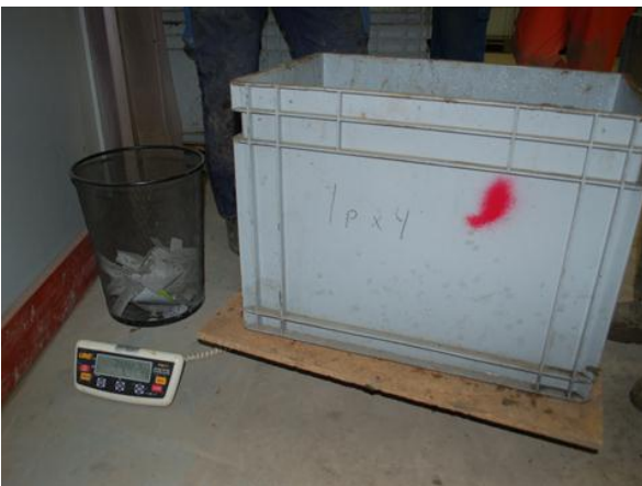
Figur 3. Invägning av samtliga prover, detta sker på en större våg på ett jämt underlag med en godkänd och kalibrerad våg. Foto: Robert Olsson
