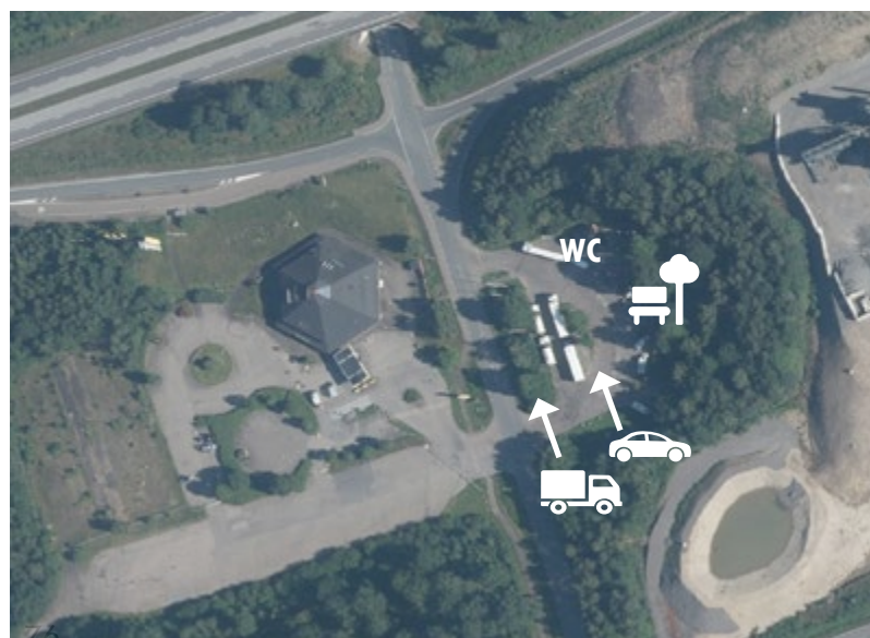
fig. 19 Mölletofta rastplats ligger en bit från vägen (dock precis bredvid en asfaltfabrik) och har ingen tydligt fysisk trafikseparering. Trots detta liknar den de exempel som Trafikverket förespråkar. Det är en liten rastplats. Den har en separering av fordon med skyltning, däremot ingen fysisk separering vilket gör att det kan bli trångt. Att ingen har långt till toaletten beror mer på storleken än dispositionen.
