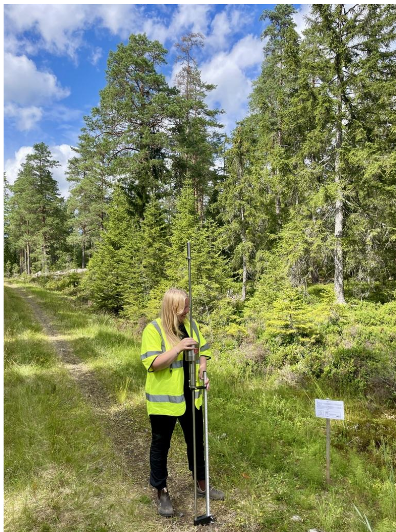
Figur 11. DCP monterad enligt instruktion, mätstocken på höger sida och vikten samt konen på vänster sida.
