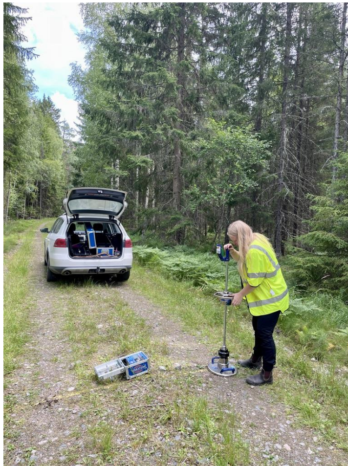
Figur 12. Terratest monterad enligt instruktion, mät datorn står mitt på vägen och den tunga lastplattan med tillhörande fjädersystem i höger hjulspår. Bilden visar även hur mät lådorna var placerade i bilen.
