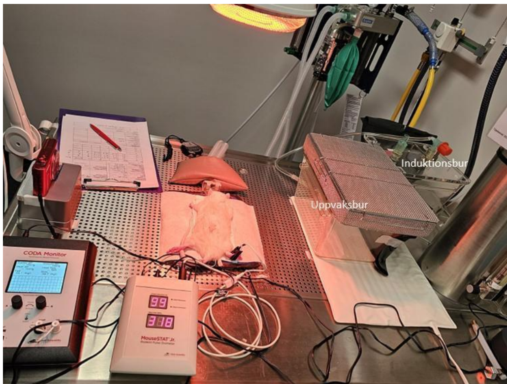
Figur 1. Wistarråtta placerad på mask under isoflurantillförsel under försökets anestesidel. Bilden visar uppställningen med mask, narkosapparat, induktionsbur, uppvaksbur, kamera samt övervakningsutrustning. Foto av författaren.
