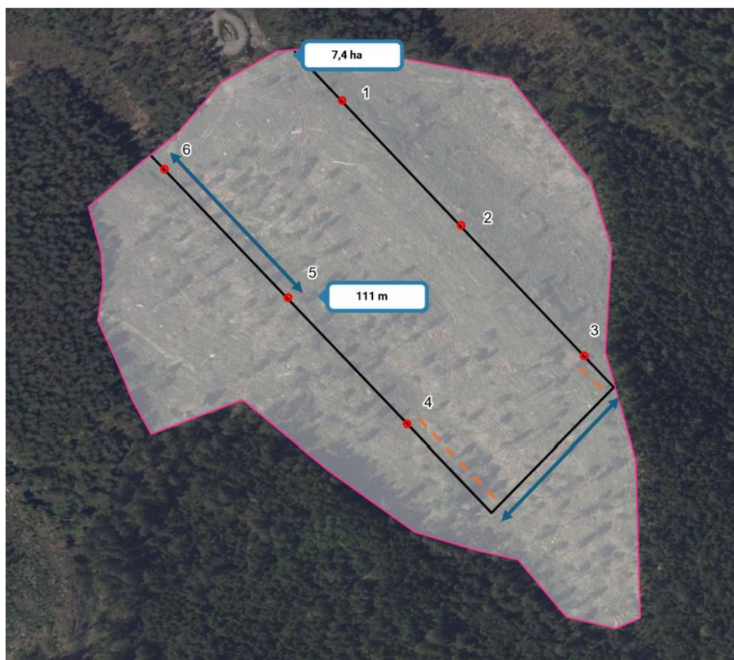
Figur 3. Illustration av utläggning av provytor genom kompassgång. Blå linje illustrerar provyteavståndet. Orangea sträckade linjer mäter tillsammans provyteavståndet vid vinkling från beståndsgrens.
