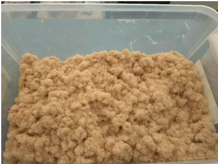
Figur 1. Granfibersubstratet som i framställningsprocessen anpassats för plantodling.
