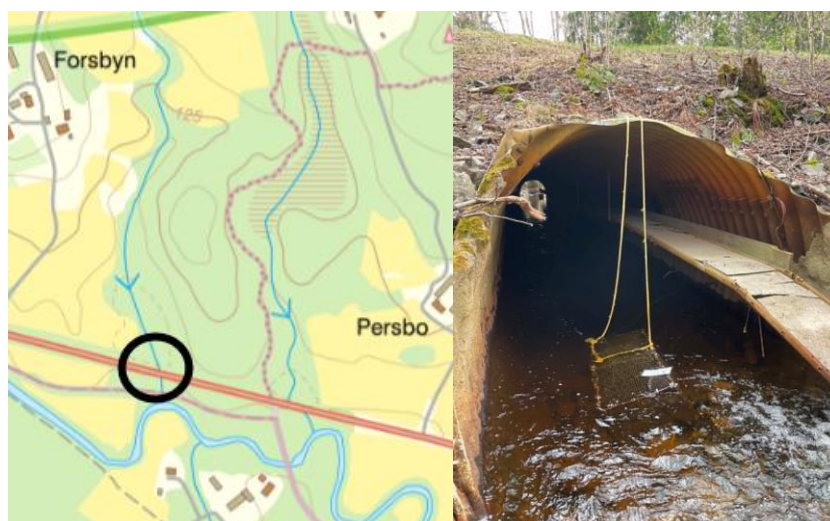
Figur 3. Kartbild visar var valvbågen är placerad (till vänster). Valvbågen med utterbräda (till höger). Foto: Marcus Wolter.
