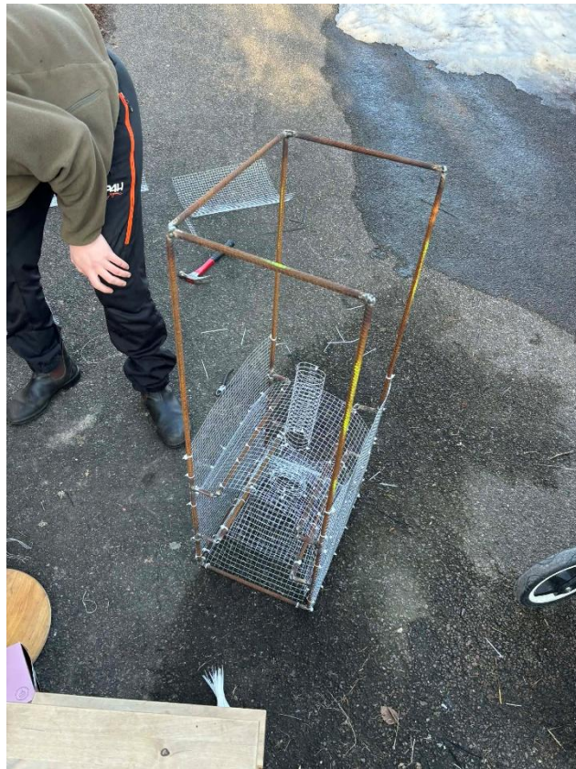
Figur 6. Inklädnad av fiskfälla, visar dess kammare samt trattfunktionen. Foto: Oskar Turzik.
