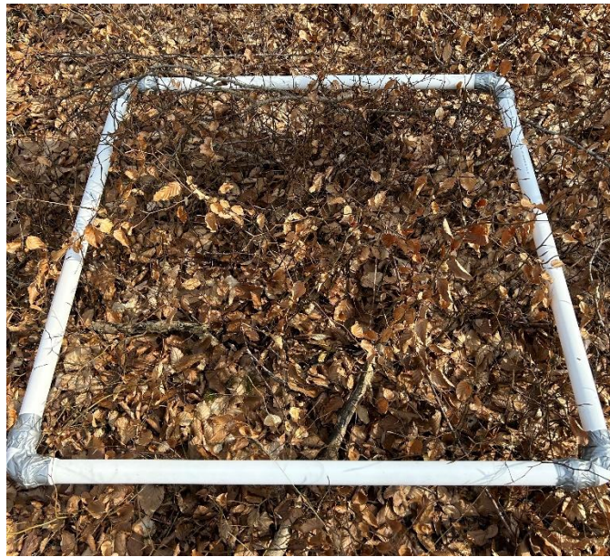
Figur 3. Kvadratrutan som användes för mätningen. Byggt med vattenrör och silvertejp.
