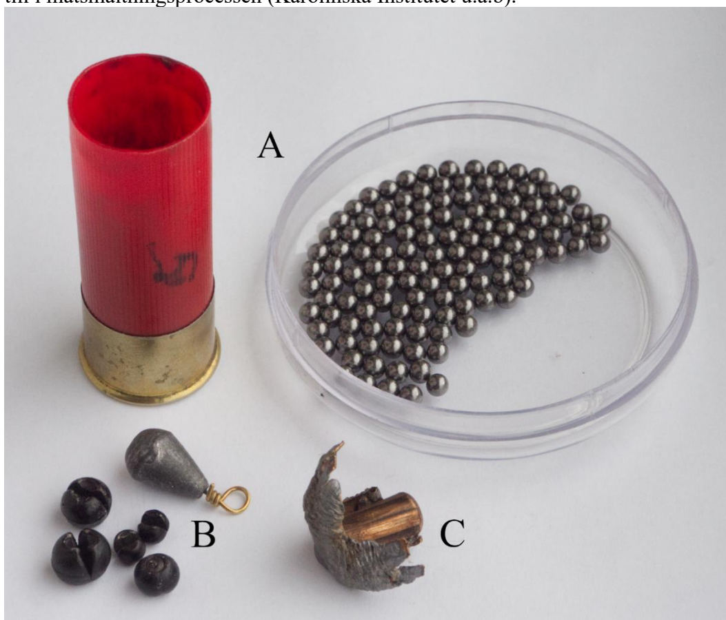
Figur 7. Olika blykällor. A visar en hagelpatron med kulorna utskurna, B visar olika typer av blysänken, C visar en avfyrad och expanderad halvmantlad kula (Foto: Robin Pollack).
