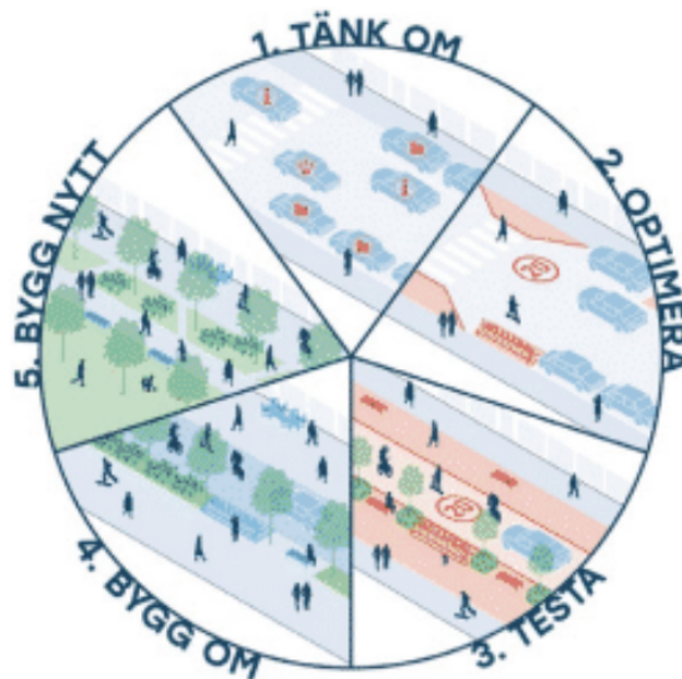
Figur 6: Spacescapes femstegsprincip för omvandling bygger på Trafikverkets fyrstegsprincip med tillägget att testa genom temporära testbäddar som testar en potentiell ombyggnad (Spacescape, 2024).
