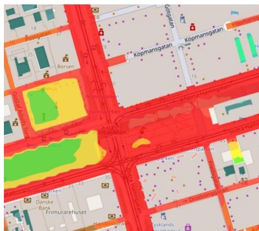
Figur 6, Bullerkarta över Brunnsparken. Röd färg antyder 65-100 dB, Orange 60-65 dB, Gul 55-60 dB, Grön 50-55 dB, Blå 45-50 dB och Grå under 45 dB.
