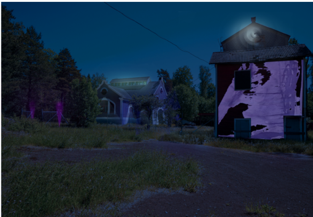
Figur 21. Konceptskiss 2:2. Ljus inifrån Kraftcentralens vind; blå och vit fasadbelysning; projektion på Gustavs Hus med motiv från fokusgruppträff 1; uppåtriktad belysning som entréljus intill Kraftcentralen.
