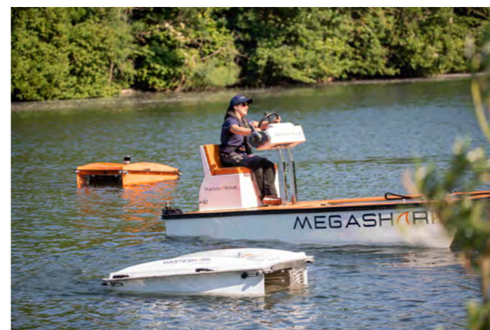
Figur 72. MegaShark, ett mindre fartyg som drivs manuellt och kan fånga upp stora mängder skräp (RanMarine 2023).
