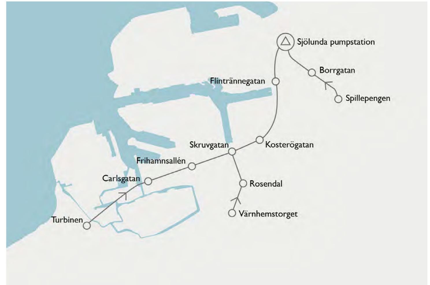
Figur 32. Överblick på MAXIMAs avloppstunnel Söder som går från Turbinen i Malmö till Sjölanda avloppsreningsverk, med två anslutande mikrotunnlar från Värnhemstorget och från Spillepengen.
