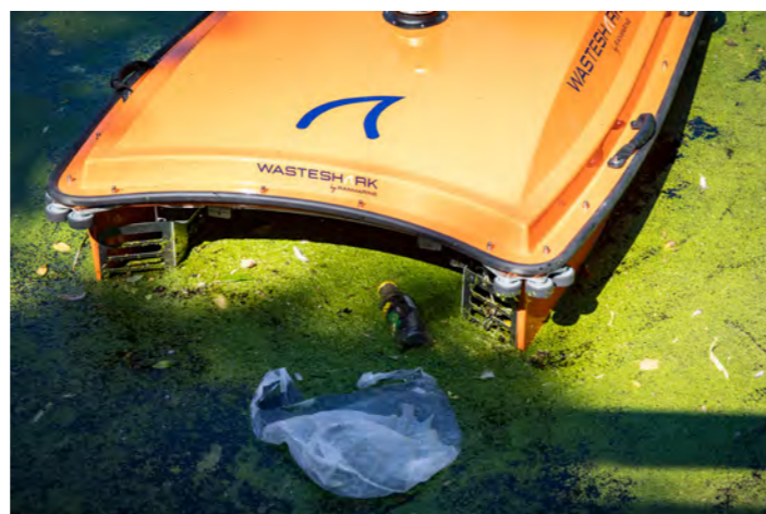
Figur 71. WasteShark, en automatiserat skräpinsamlare som fångar upp flytande skräp och biomassa (RanMarine 2023).
