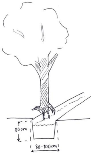
Figur 6. Skiss som visar princip och mått för de öppna vattenkanalerna acequias . Konstruktionen möjliggör att vattnet kan ledas vidare i sidled samt bevattning för intillplanterade träd. Illustration: Agnes Englund
