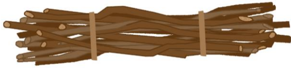
Figur 20. Illustration som visar en faskin, hopbuntade genar och kvistar (Eriksson 2025)
