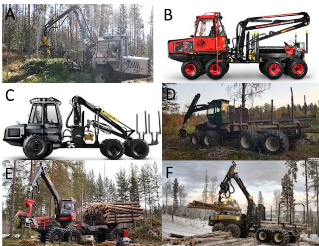
Figur 1. Olika tillverkares EMS. A: Vimek kombi (Vimek AB), B: Terri 3WC (Terri AB), C: Malwa 560C kombi (Malwa AB), D: Pika 828 drivare (Skogsforum), E: Komatsu x19 drivare (Skogforsk), F: Ponsse Dual kombimaskin (Skogforsk).
