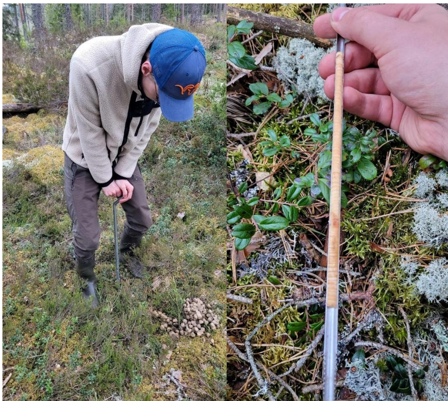
Figur 4. Kontroll av jorddjup samt jordart för bonitering med SIS (vänster) samt avläsning av ålder via årsringar för bonitering med SIH (höger).
