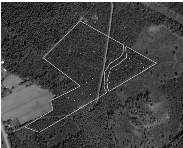
Figur 5. Ett exempel på ett av objekten där gallringsobjektet är delad, vilket resulterade i 20 provytor i varje område. Här skapades det först 40 provytor för att sedan bli 20 provytor med hjälp av Subset Feature
