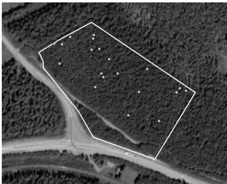
Figur 4. Ett objekt med ett slumpmässigt urval av 20 provytor som har placerats ut med hjälp av de verktyg som finns i ArcGIS pro . Punkterna inom polygonen (objektsgränsen) är de cirkelprovytor som inventerades.
