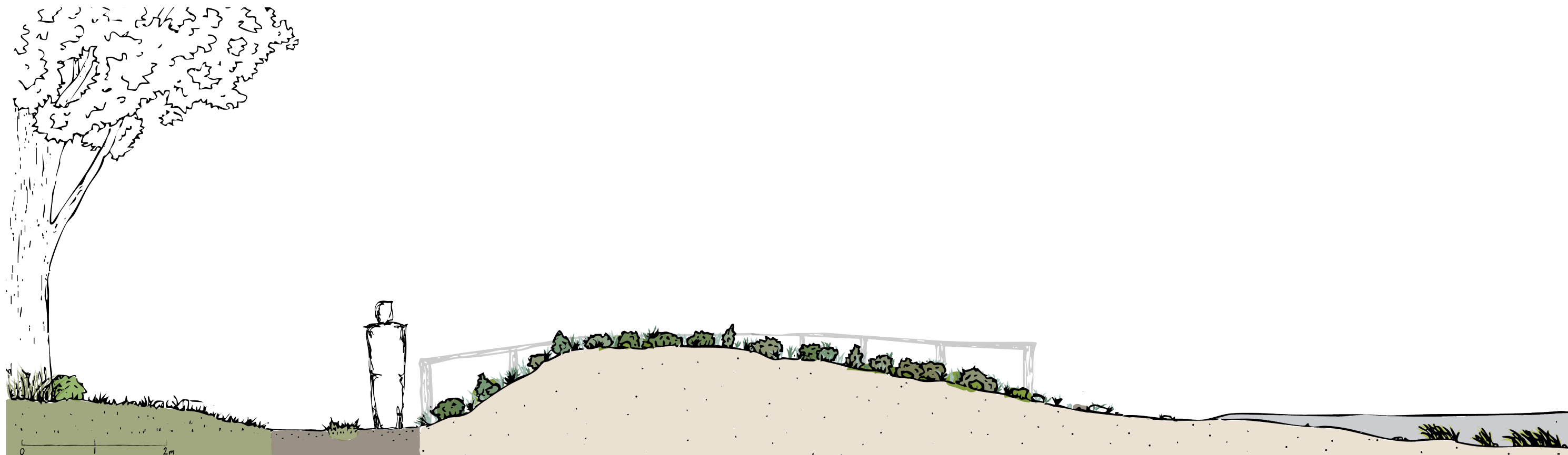
Figur 51. Illustrationen visar lösningsförslaget för Örnahusen i sektion där strandfodring och dynbildning utförts och vegetationen är i en tidig fas av etablering. Vegetationsdelen av skyddet mot kusterosion är känsligt efter planteringen och kan behöva underhållas samt fyllas på innan de etablerat sina rötter ordentligt. För att förhindra att människor stör etableringen kan staket eller liknande uppföras. Ålgräs har planterats för att gynna den biologiska mångfalden i havet och på havsbotten. Planteringen av ålgräs bidrar även till renare vatten, då växten binder koldioxid, samt binder material på havsbotten och på så sätt mildrar erosionen på platsen. Illustration: C. Petersson, 2025.
