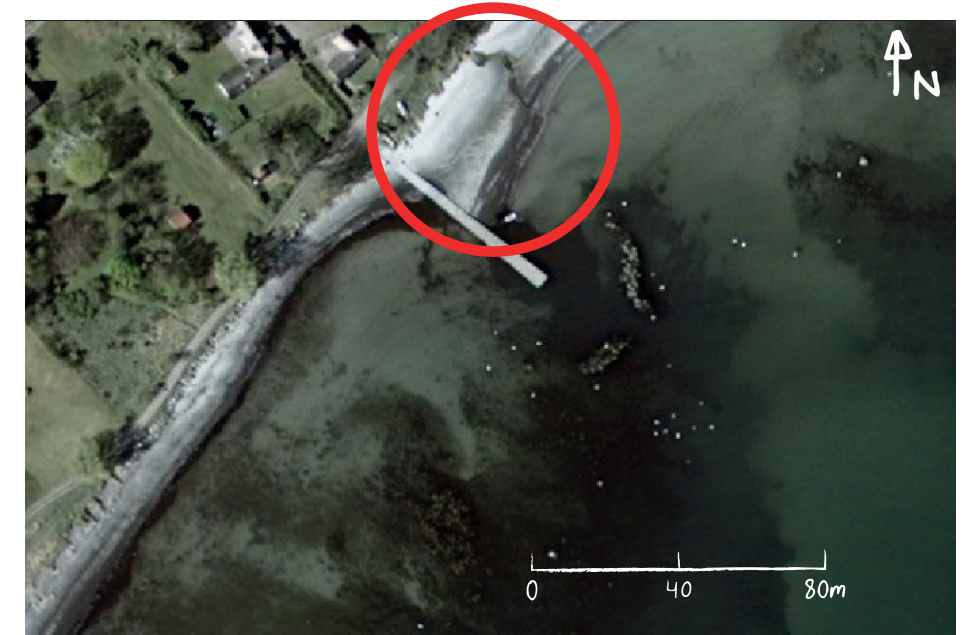
Figur 23. Bilden visar ackumulation på bryggans uppströmssida, det vill säga dess norra sida. Ortofoto från Lantmäteriet, 2007. Fotografi/illustration: C. Petersson, 2025.
