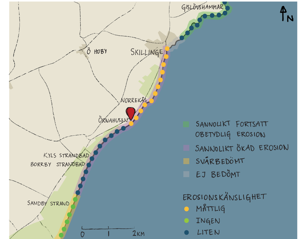
Figur 30. Erosionsförhållande vid havsnivåhöjning på ca 1m och erosionskänslighet längs med kusten utanför Örnahusen, baserad på karta från SGU, 2025. Illustration: C. Petersson, 2025.
