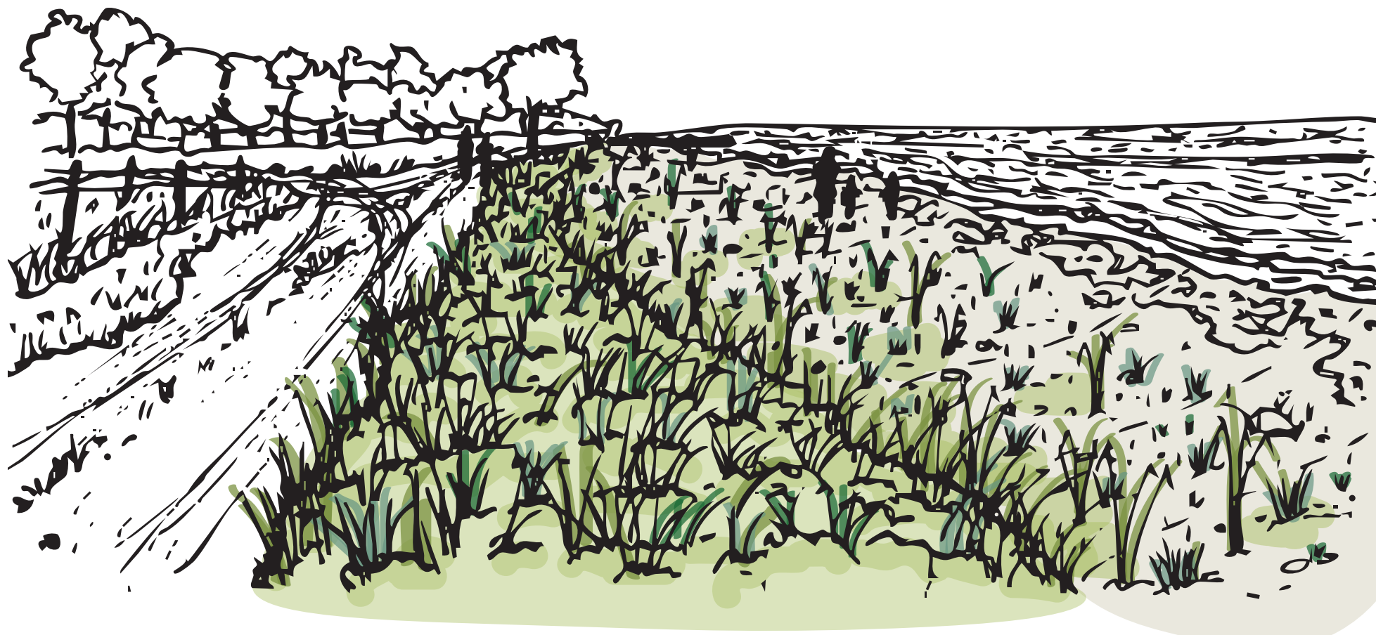
Figur 42. Skiss över Örnahusens strand efter implementering av lösningsförslaget. Nu har strandfodring gjorts, nya sanddynor har bildats och vegetation i form av bland annat sandrör, strandgräs och marviol har planterats. Illustration: C. Petersson, 2025.
