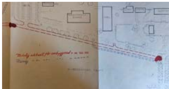
Figur 31. En ritning på omläggning av bilväg av Nääs allé 1972. Den nya vägen är ritad i rött.
