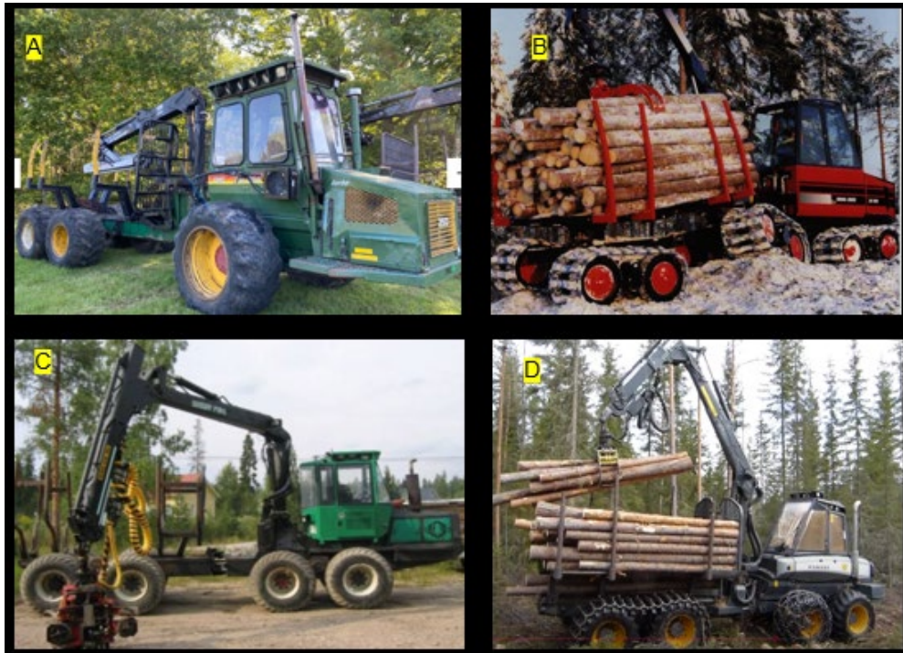
Figur 6. Kombimaskiner. A: FMG 250, Foto: Klaravik auktion. B: Nokka-Joker kombi, Foto: Nokka Forest. C: Pika 728 Combi, Foto: Lecture, D: Ponsse Wisent Dual, Foto: Heavy equipment.
