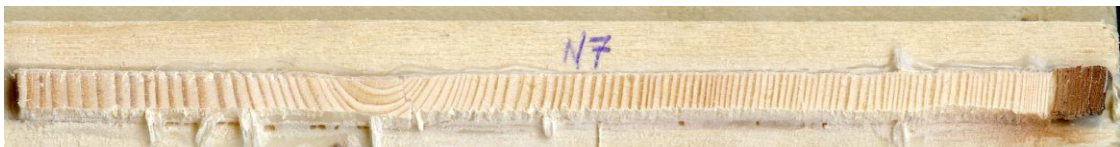
Figur 5 Exempel på trästicka med hel borkkärna fastlimmad, som slipats plan.
