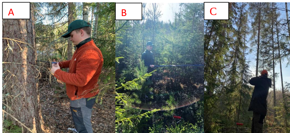
Figur 3. Exempel på fältdatainsamling. A): en tall åldersbestäms med hjälp av ett åldersborr, B): stammantalet i en ungskog uppskattas med hjälp av ett Röjspö, C): grundytan i ett äldre bestånd uppskattas med hjälp av ett relaskop.
