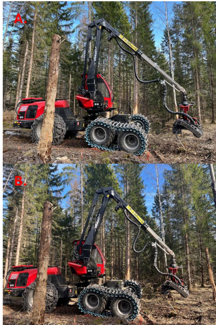
Figur 16. Ett problem som noterades under försökets gång var att eleverna antingen glömde bort eller förbisåg att dra in utskjutet mellan varje träd. (A) Här är utskjutet nästa max utskjutet. (B) Här är utskjutet ungefär till hälften utskjutet. Bilderna är inte tagna under en faktisk försöksomgång, utan tagna i efterhand.
