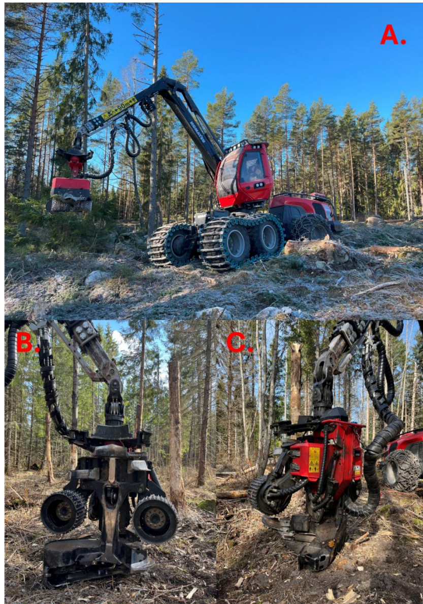
Figur 4. (A) Maskinen som användes i försöket var en 6-hjulig Komatsu 911 av årsmodell 2024 utrustat med ett S92 aggregat på en C6 kran. Skördaren var utrustad med band på fram boggin och med kedjor på bakhjulen. (B, C) Aggregatet har en aggregatöppning på 530 mm (Komatsu 2025).
