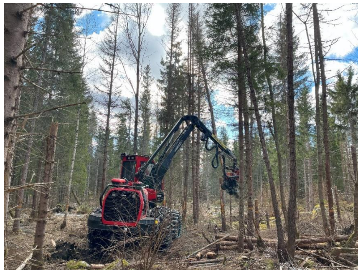
Figur 8. Pågående arbete med att göra högstubbar av de träd som var angripna av granbarkborre. Maskinen som nyttjades var den Komatsu 911 som var med i försöket. Höjden på högstubbarna var cirka 4 m.
