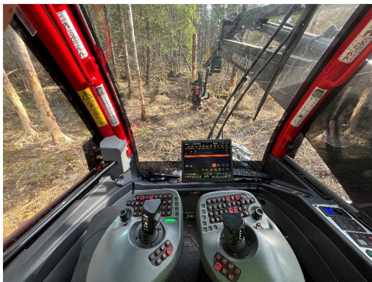
Figur 5. Förarvyn inne i hytten, där det finns två joysticks med tillhörande knappaletter. På baksidan av varje joystick sitter fyra knappar, där ena knappen för att tilla ner aggregatet sitter. I hytten finns en skärm där både kartor och maskinens instrumentering kan visas.
