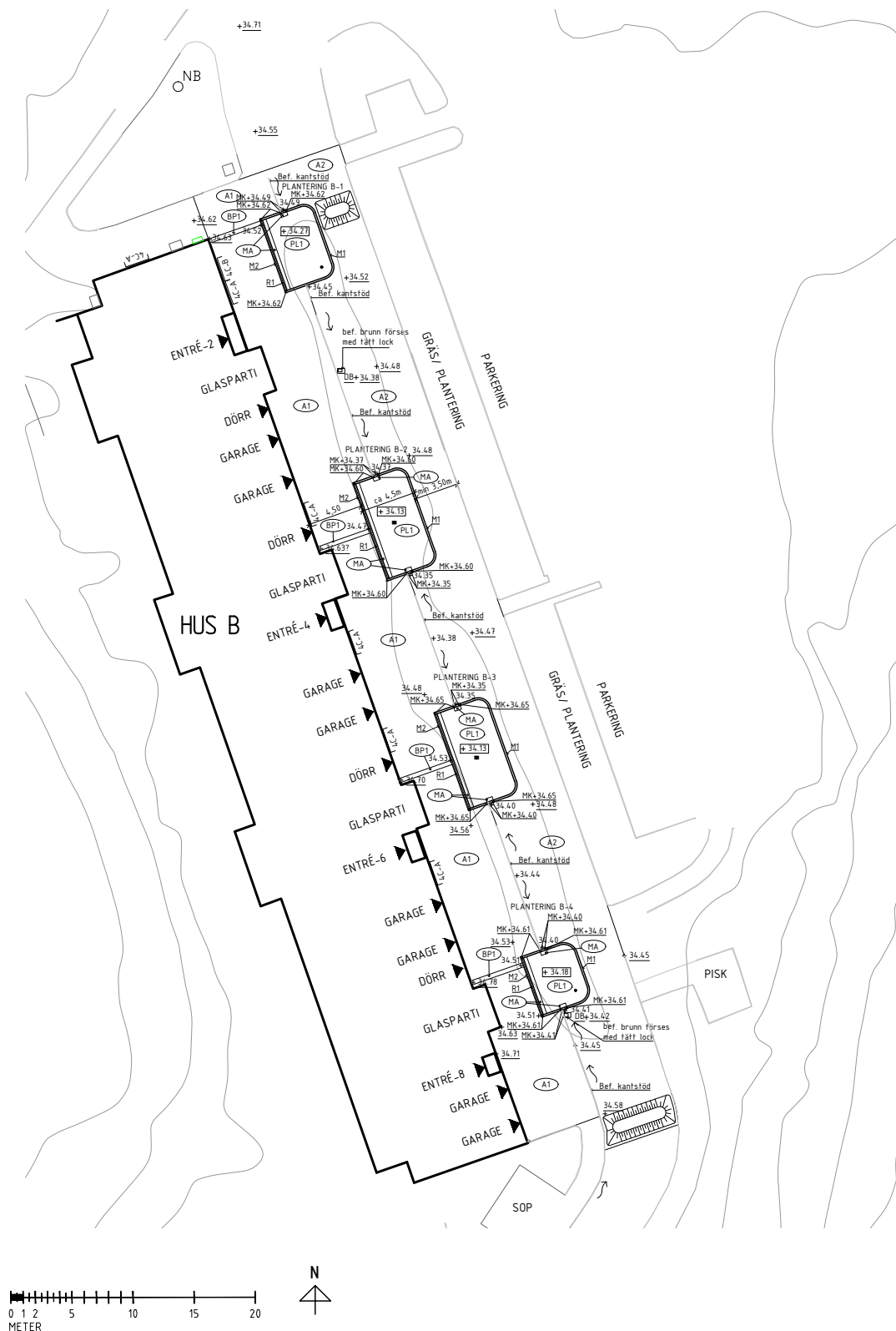
Figur 42. Plan över regnbäddarna intill hus B. Det går att se regnbäddarna i sitt sammanhang och hur de spelar en viktig roll i att ta upp vattnet som rinner ner från berget till höger innan det når huskroppen. Ritningen är gjord av Sweco 2019 på uppdrag av Telge bostäder.
