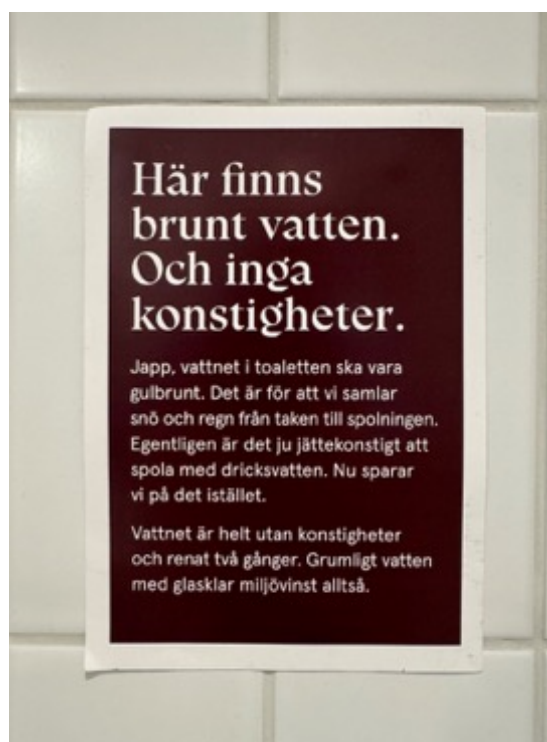
Figur 33. Informationsskylt om missfärgning av spolvattnet till följd av regnvattenåtervinning (Ferm 2025).
