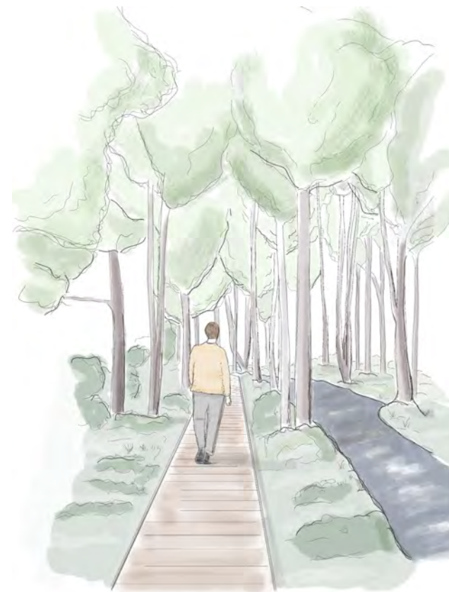
Figur 51. En 1,2 meter bred spång i trä leder genom den fuktigaste delen av sumpskogen. Konstruktionen möjliggör tillgänglighet utan att skada markens ekologiska struktur, samtidigt som den behåller ett lågmålt uttryck i landskapet.
