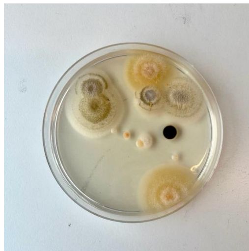
Figur 8. Exempel på agarplatta med mjölprov. Prov 19 med spädning (1 \cdot 10)^{-3} g/l som växt på DCMA. Observerbara kolonier av Alternaria (grå) och Cladosporium (svarta) samt oidentifierade vita och gula kolonier.
