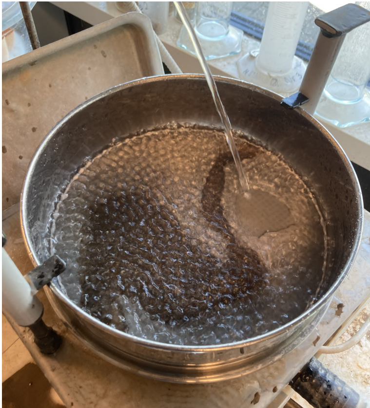
Figur 15. Andra tvätt för att avlägsna kvarvarande organiskt material. (Foto: Carl Flädjemark).
