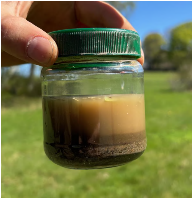
Figur 12. Sedimenteringstestet efter 2,5h (Foto: Carl Flädjemark).
