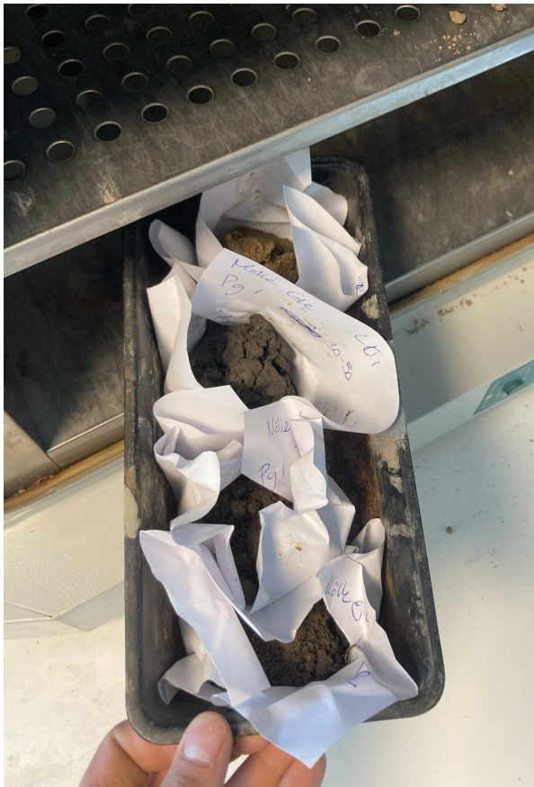
Figur 14. Torkning av jorden efter första tvätt. (Foto: Carl Flädjemark).
