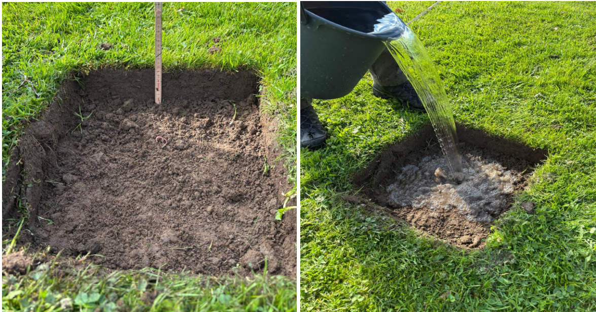
Figur 10. Utgrävningen på 50x50x10 cm för infiltrationstest (Foto: Martin Möller).
