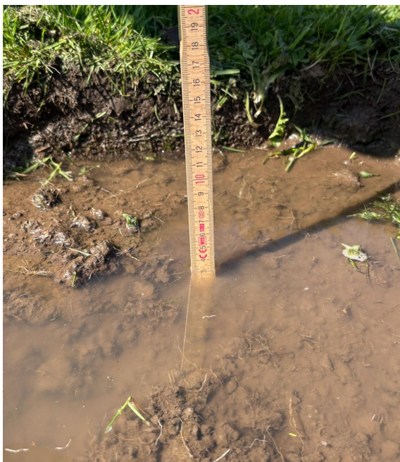
Figur 11. Vattennivån hade efter 2,5 timmar sjunkit 30 mm vilket indikerar att jorden har en infiltrationshastighet på 10mm/h (Foto: Martin Möller).
