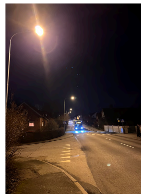
Bild 66. Belysning av större väg i ett nyare område i Ystad, där armaturen är 10 m hög, 64 LUX och ett spillljus som "inkrär" på omkringliggande bostäder.
