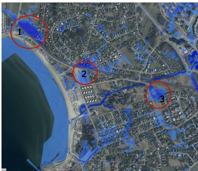
Figur 24: Simulering av största vattendjup vid skyfall år 2023 i Apelviken, med befintlig banvall och en havsnivå på +0,06. Röda cirklar markerar problemområden (Gohblit et al. 2023).
