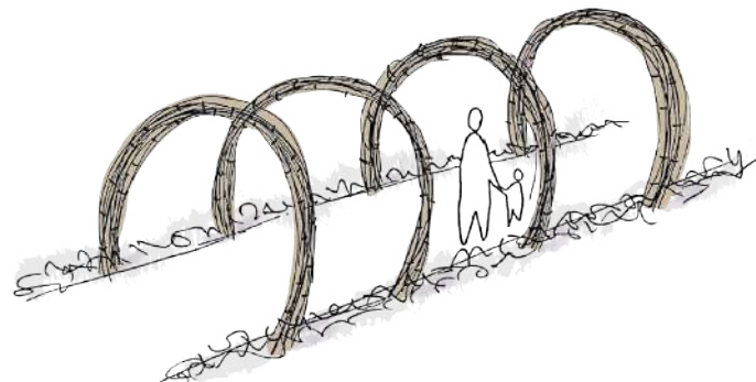
Stålbågar förankras i marken och kläs med ris eller slanor.
