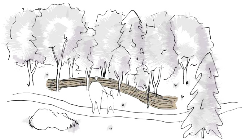
Befintligna stammar används istället för störrar.
