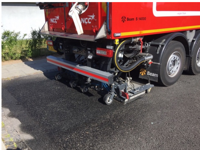
Figur 9. Bakre del av NCCs sopmaskin för rengöring av permeabel asfalt som högtryckstvättar, sopar och suger upp partiklar (Brask 2024).
