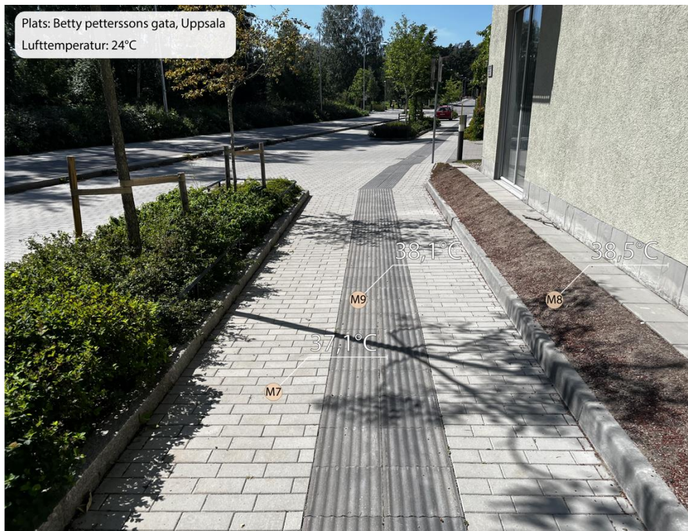
Figur 10: Bilden visar resultatet från temperaturmätningen av mätpunkterna M7-M9. M7 och M9 är mätta i full sol, medan M8 är mätt i skugga.
