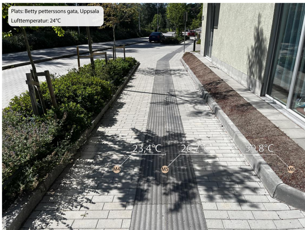
Figur 9: Bilden visar resultatet från temperaturmätningen av mätpunkterna M4-M6. M4 och M5 är mätta i skugga, medan M6 är mätt i full sol.
