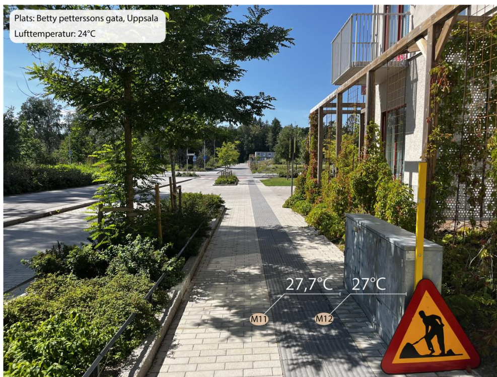
Figur 12: Bilden visar resultatet från temperaturmätningen av mätpunkterna M11-M12. Båda mätpunkterna visar temperaturen i skuggat läge med två olika typer av material
