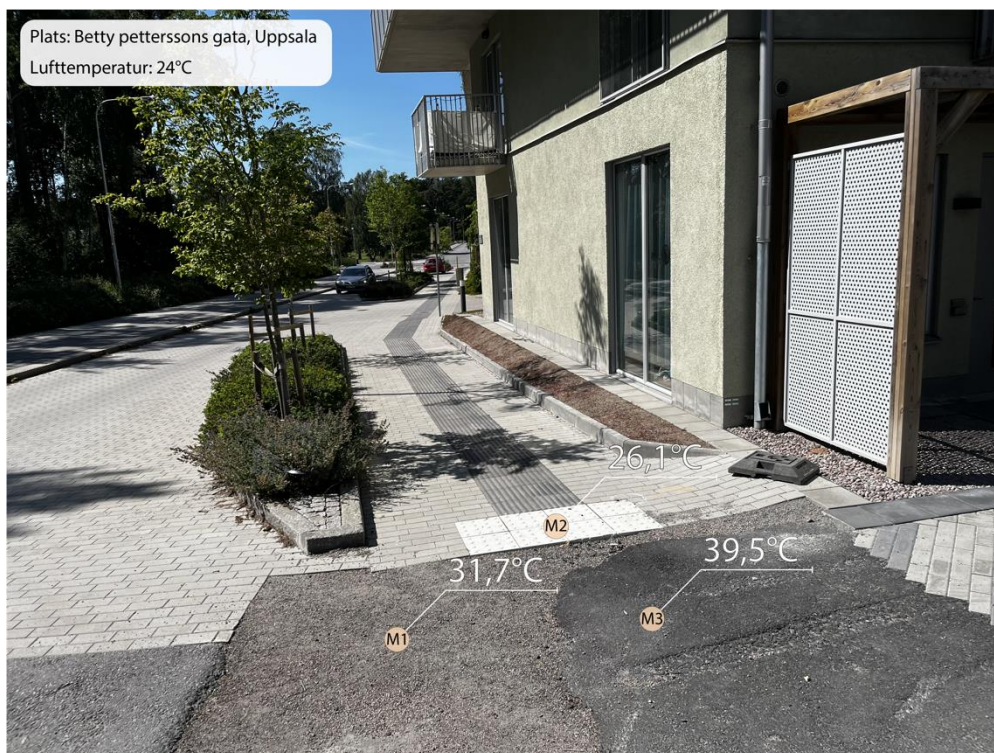
Figur 8: Bilden visar resultatet från temperaturmätningen av mätpunkterna M1-M3. Där M1 är mätt mot grus, M2 mot en vit valpunktsplatta och M3 mot mörk asfalt.
