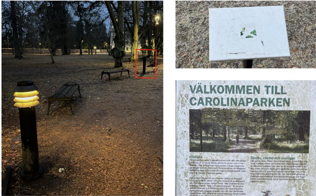
Figur 6. Till vänster: En av tre ljuskällor i parkens allé som är trasig. Till höger: Informationsskyltar i dåligt skick med algbildning och avsaknad av information. Dessa faktorer förstärker intrycket av en mindre välskött park. (Foto: Angelina Kilimova)
