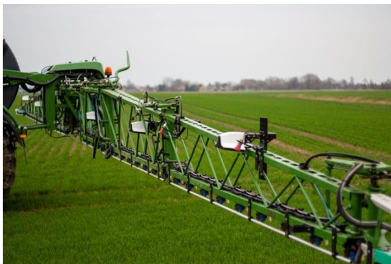
Figur 6. DATs kamera installerad på spruta (Källa DAT)
