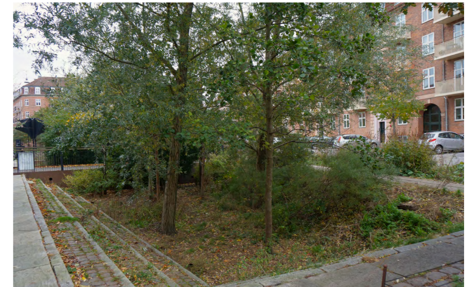
Figur 59. Nedsänkta växtbäddar för dagvattenhantering (Wigbratt 2024)
