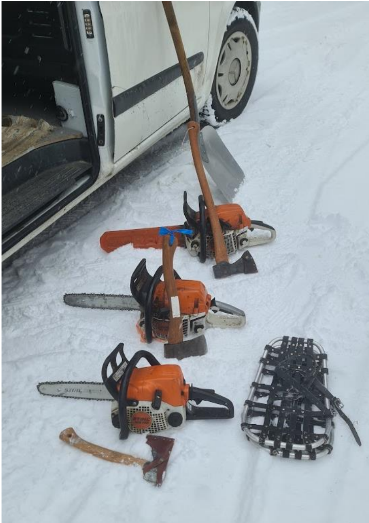
Figur 2. Den semimanuella utrusningen. Valet landande på den närmaste yxan (Gränsfors Vildmarksyxan) och den närmaste motorsågen (Stihl MS 170). Bakom sågen längst bort syns spaden och till höger snöskorna.
