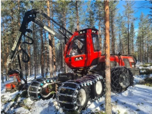
Figur 1. Den mekaniserade utrustningen: En Komatsu 901 skördare, med S82 aggregat. Notera nedre kvistkniven och matarvalsarna på aggregatet (källa: Komatsu Forest).
