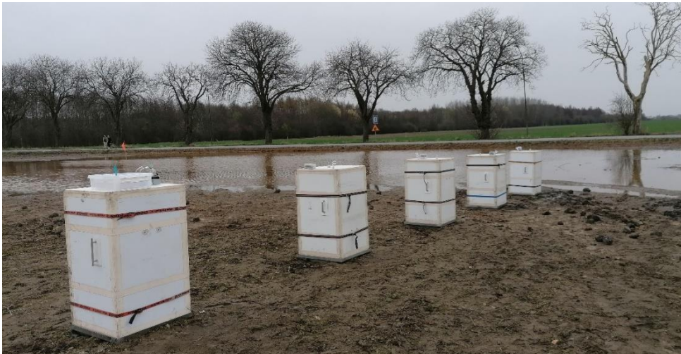
Figur 5. Kamrarna och deras placering under pågående gasmätning. Närmast i bild är grupp A och längst ifrån är grupp E.
