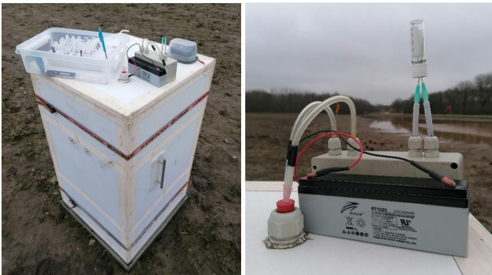
Figur 6. Bilden till vänster visar mätutrustningen under pågående gasmätning och bilden till höger pumpen som cirkulerade luften från kammarens insida till provröret genom gummiproppen (röd) på kammarens ovsida.
