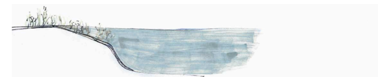
Figur 28. En begynnande svag lutning som sedan övergår till brantare ger också en bredare zon för vegetation där det fortfarande är grunt, och möjliggör för en större vattenvolym på en mindre yta.
